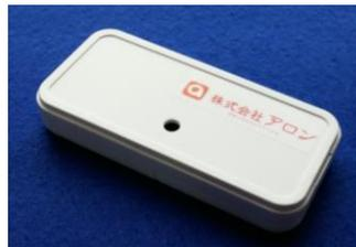
写真は、温度・湿度・気圧無線センサーです。
